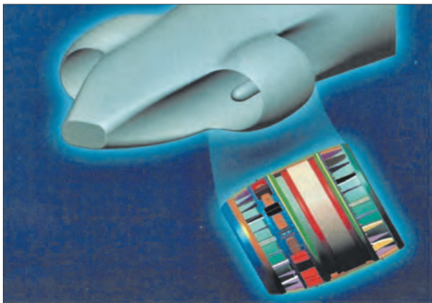
Вариант двигательного-движительного комплекса, размещаемого в гондоле вне прочного корпуса ПЛА
