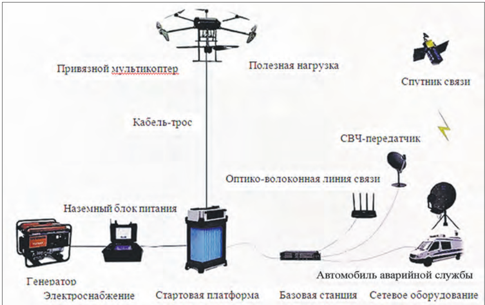
Состав и схема применения привязного мультикоптера
