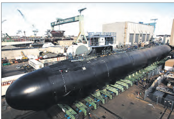
Строительство ПЛА типа «Виргиния» на верфи компании «Ньюпорт ньюс шипбилдинг»
