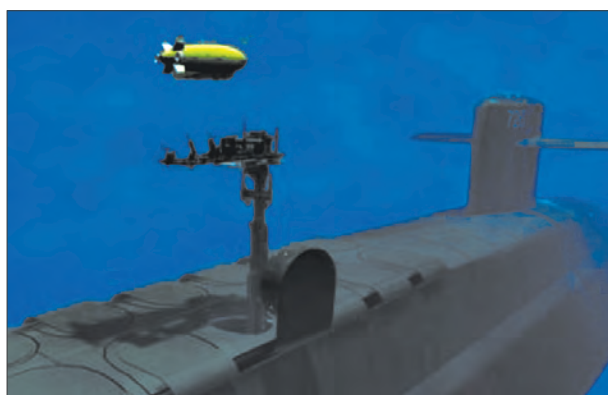
Система выпуска-приема АНПА на ПЛАРК типа «Переоборудованная Огайо»
